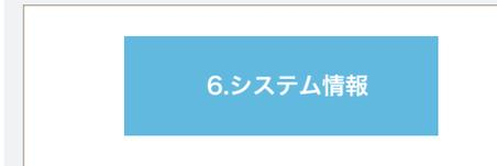
右ボタン「▷」を6回押して、「6. システム情報」を選び、「□/◁」を押すと、液晶パネルに現在のファームウェアのバージョンが表示されますもう1度「□/◁」を押すと本体シリアル番号が表示されます
