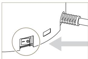
iDrip本体の電源プラグをコンセントに差し込んであることを確認して、iDrip本体後ろの電源スイッチをONにする
