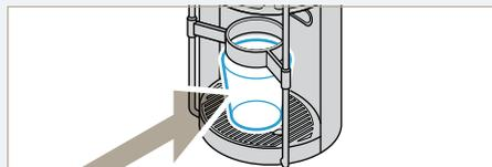
トレイに150ml程度の容量のカップを置き「□/◁」を押すと、加熱したお湯を数秒間排水します
