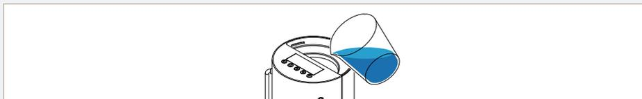
5. クエン酸のにおいを取るため、水タンクが空になってから、700mlの水またはお湯(約80°C-100°Cの熱湯をおすすめします)を入れた後、もう1度「4. 水を排出」機能で湯通しをします
